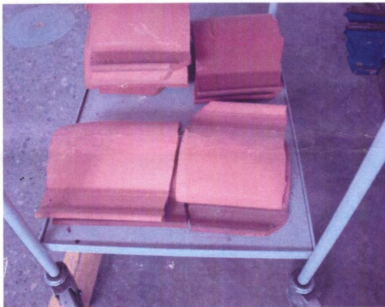
Figura 2. Tejas sometidas al ensayo de flexión
