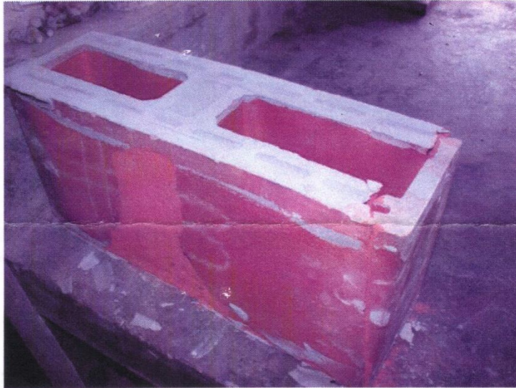
Figura 3. Bloques de arcilla con capping de yeso cemento ensayados a compresión
